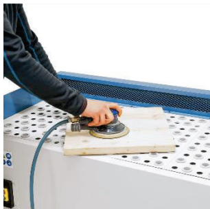
Gummierte Tischauflagen verhindern ein Zerkratzen des Werkstückes
