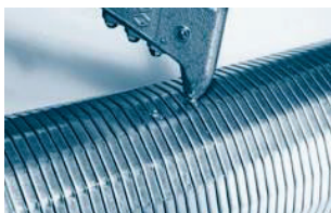
Schritt 1: Spätere Enden mit Niete n oder durch Verlöten fixieren.
