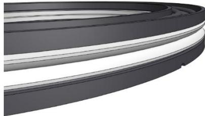
(!) Beim Wiedereinbau des Dichtungsstapels ist es wichtig, die abgerundeten Seiten der weißen POM-Dichtungen zu beachten: Sie müssen in der Mitte ausgerichtet sein, wie im Bild gezeigt.
