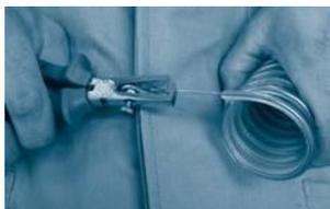
Schritt 2: Entweder Kunststoff mit einer Abisolierzange abziehen...
