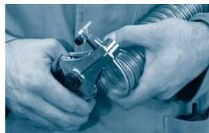
...oder komfortabel mit einer speziellen Abisolierzange entfernen.
