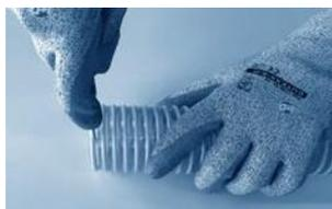
Schritt 1: ½ Umfang der Schlauchwandung entlang der Hartkunststoffwendel auf der offenen Seite des Schlauches neben der Litze so einschneiden, dass die Litze in der nicht abgeschnittenen Schlauchwandung verbleibt.
