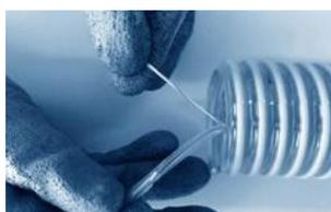
Schritt 5: Erdungslitze und Kunststoffwandung durch Ziehen mit den Fingern vorsichtig voneinander trennen. Loses Ende der Kunststoffwandung mit dem Seitenschneider abknäufen.
