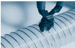
Schritt 2: Stützwendel mittels Zange durchtrennen.
