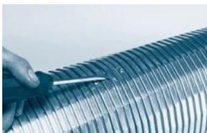
Schritt 2: Mit Schraubendreher Profil aushebeln.
