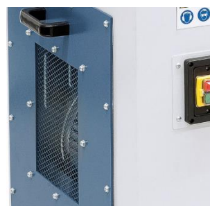
Durch die seitliche Öffnung wird die gefilterte Luft dem Arbeitsraum wieder zugefügt.
